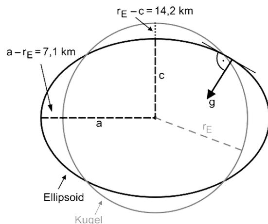
Abbildung 2: Illustration des Erdellipsoids. Quelle: Clauser, Einführung in die Geophysik
