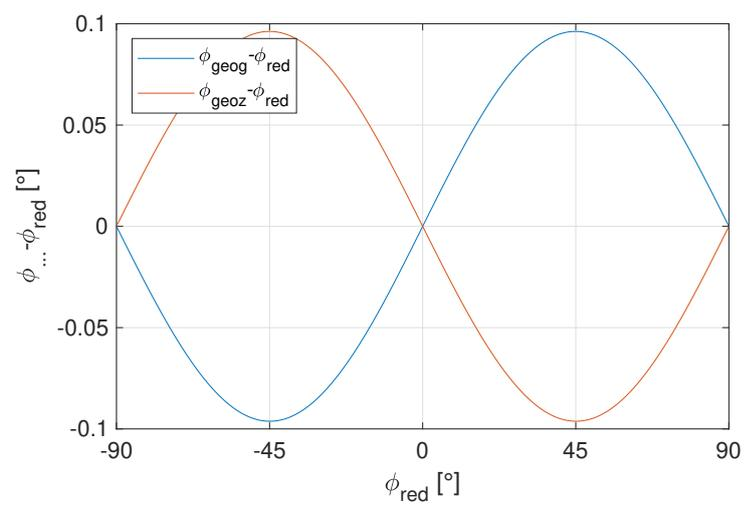
Abbildung 4: Differenz zwischen geographischer, reduzierter und geozentrischer Breite nach Gln. 9 und 13.
